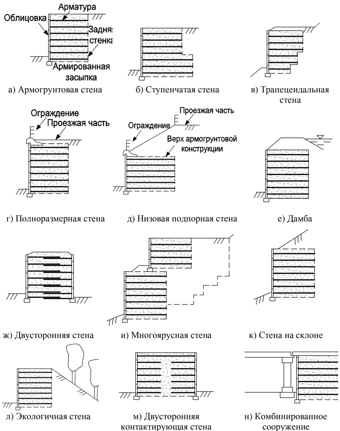
Рисунок 9.2 - Основные типы армогрунтовых стен
